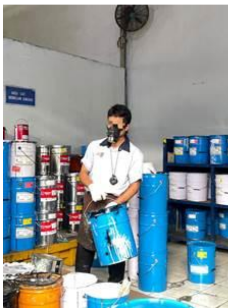
Gambar 2. Area mixing cat dan penggunaan APD oleh pekerja PT. LMN
